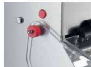
Microinterruttore di sicurezza sulla protezione Safety micro-switch on lid
